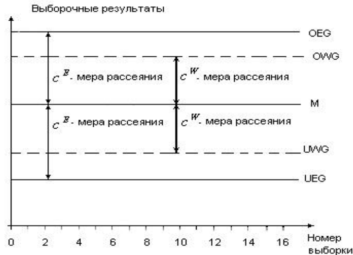
Рис. 1. Схема двусторонней контрольной карты для управления по уровню настройки
