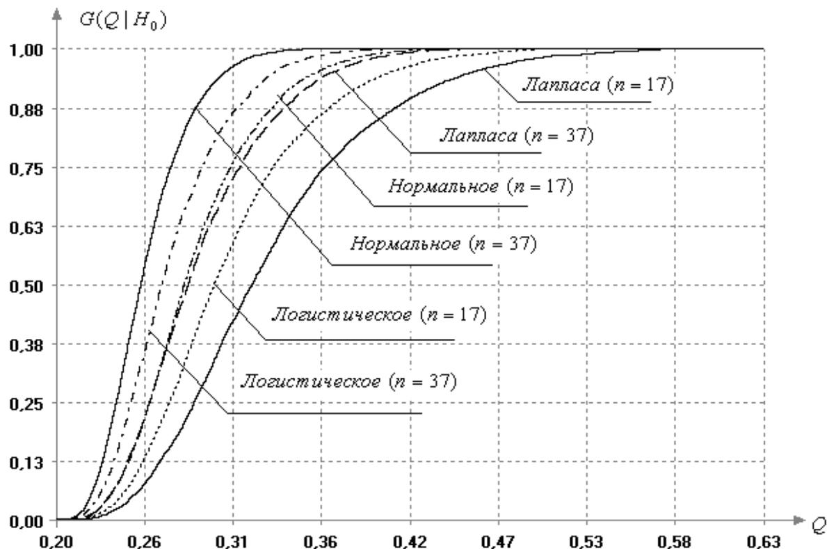
Рис. 5. Функции распределения статистики критерия Кокрена при отклонении закона распределения наблюдаемого показателя от нормального при различных объемах выборки при  $m = 5$
