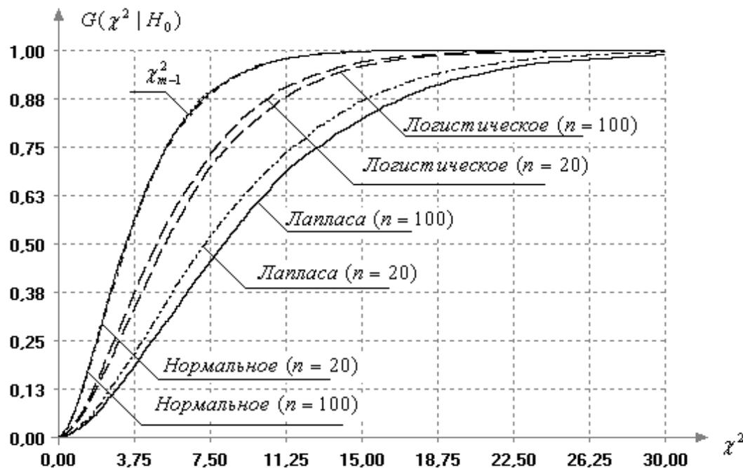
Рис. 2. Функции распределения статистики Бартлетта при отклонении закона распределения наблюдаемого показателя от нормального при различных объемах выборки и  $m = 5$
