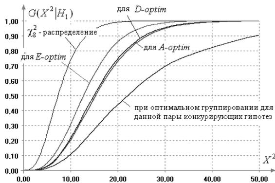
Рис. 1. Распределения статистик критерия  $\chi^2$  Пирсона при справедливости простой проверяемой гипотезы  $H_0$ , соответствующей нормальному закону, справедливости конкурирующей  $H_1$ , соответствующей логистическому, для  $k=9$  и  $n=500$
